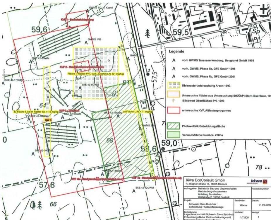
Für diese vier Kontaminationsverdachtsflächen sind die Untersuchungen bis zur Phase IIIb vollständig abgeschlossen. Sie wurden gemäß der Arbeitshilfe Boden/Grundwasserschutz des Bundes in die Flächenkategorie A bzw. B eingeordnet. **Dies bedeutet, dass von der Kontamination momentan keine Gefährdung ausgeht.** Bei einer Nutzungsänderung ist
